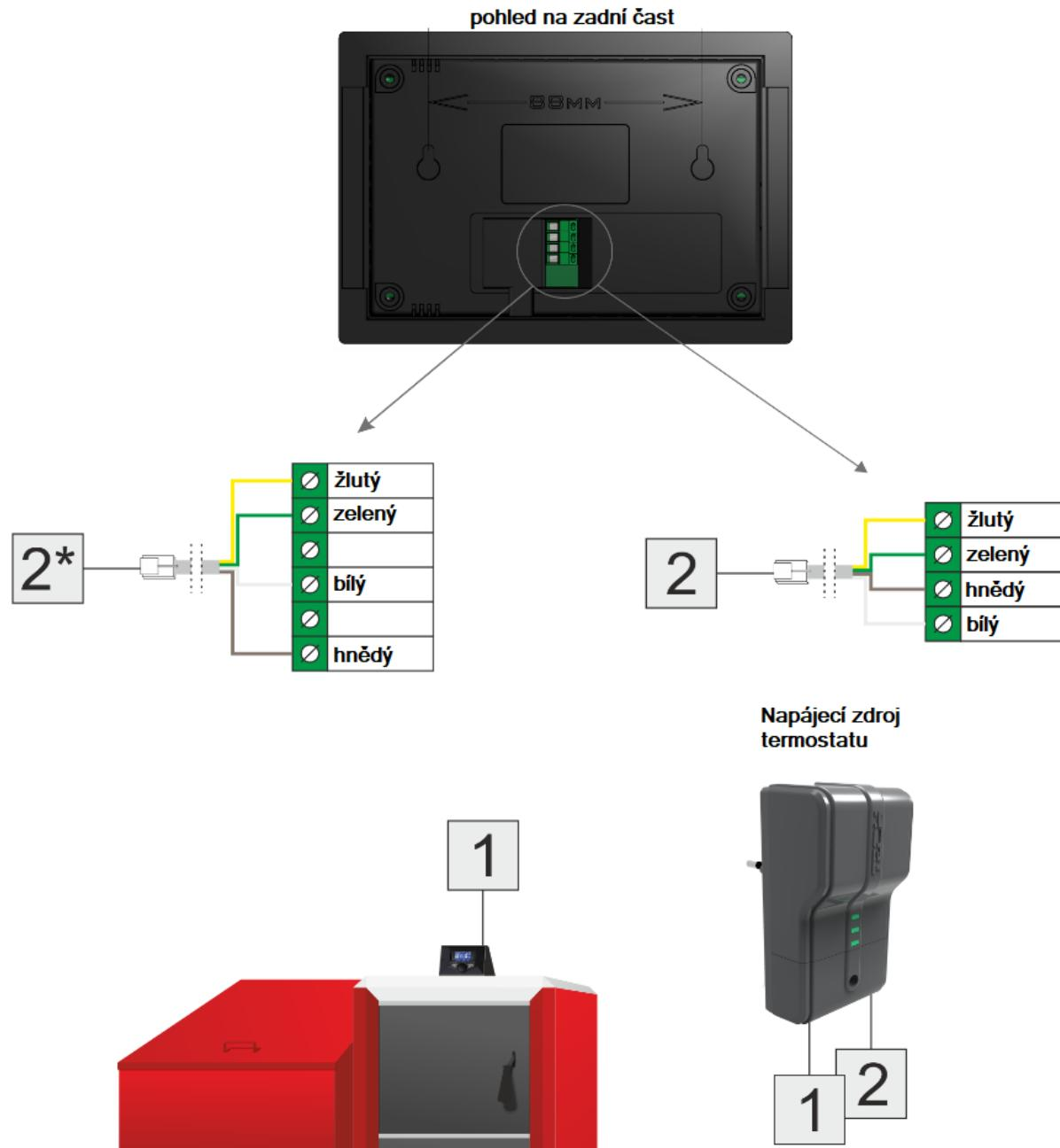
Volné vodiče kabelu se zapojí do šroubovací svorkovnice termostatu přesně podle barev. Druhý konec kabelu vybavený konektorem RJ-12 se zapojí do zásuvky zdroje označené číslicí [2]. Druhý 4vodičový kabel se připojí pomocí konektorů RJ-12 ke zdroji [1] a k samotnému regulátoru [1].
