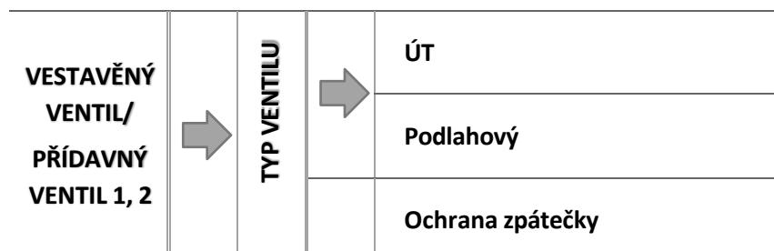
Tato volba slouží pro nastavení typu směšovacího ventilu. Volit lze mezi ventily:
