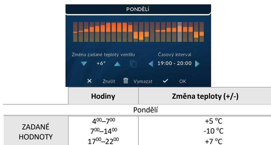
*V tomto případě, pokud je zadaná teplota kotle 50 °C, pak v pondělky od 4<sup>00</sup> do 7<sup>00</sup> hodin se zadaná teplota kotle zvýší o 5 °C tedy bude mít hodnotu 55 °C, v době od 7<sup>00</sup> do 14<sup>00</sup> hodin se sníží o 10 °C na hodnotu 40 °C, a dále v době od 17<sup>00</sup> do 22<sup>00</sup> se zvýší na 57 °C.*
